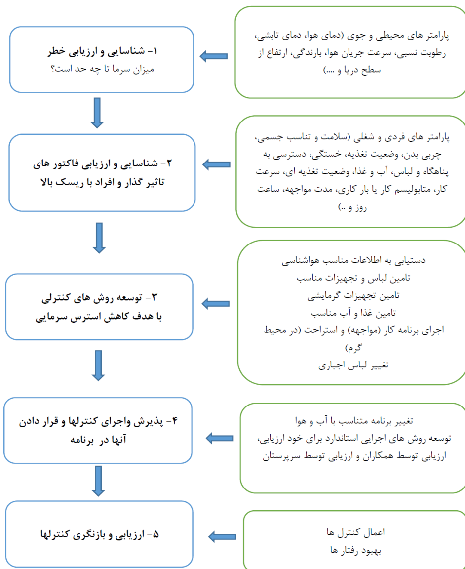
شکل ۱. فرایند مدیریت ریسک برای ارزیابی استرس و فشار سرمایی
